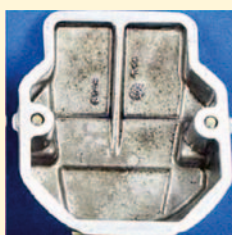
Pokrywa wahacza po użyciu oleju Shell Rimula R6 LME.
